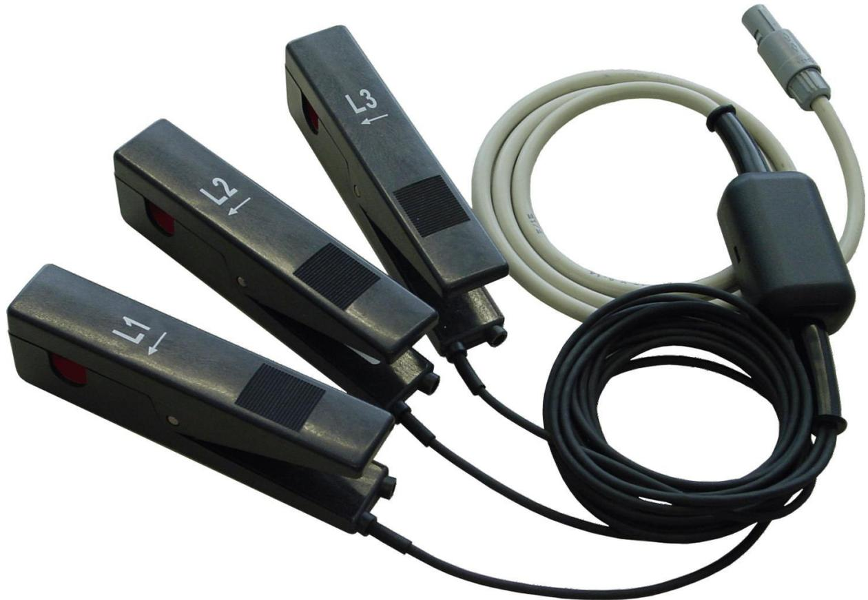
Las pinzas de intensidad electrónicamente compensadas han sido diseñadas para la medida de corrientes en el rango de 10 mA hasta 100 A. Su pequeño tamaño hacen de ellas que sean particularmente manejables sobre todo cuando se trabaja en espacios reducidos, como por ejemplo en instalaciones de contadores o en instalaciones de I.C.P. (Interruptores de Control de Potencia).
